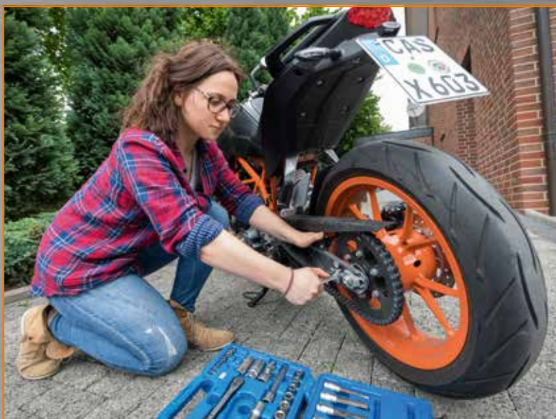
Kette spannen? Kein Problem für Veronika. Am Wochenende werden Garage und Einfahrt des elterlichen Hauses schon mal zur Motorrad-Werkstatt.
